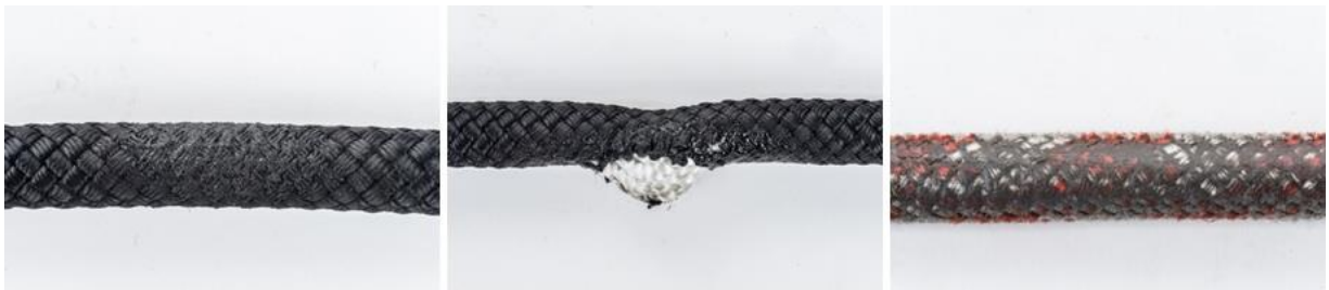
Obr. 20: Prepálenie opletu vplyvom trenia.
