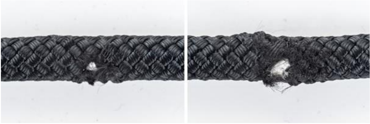
Obr. 18: Pretrhnutie viacerých prameňov opletu.
