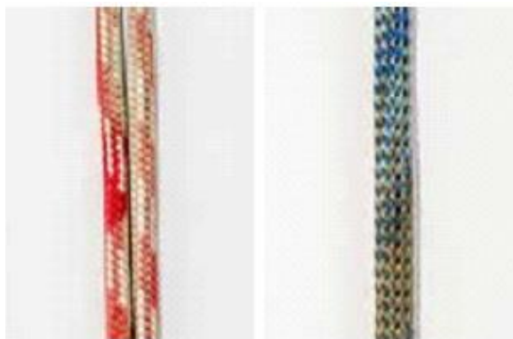
Obr. 15: Zmena farby opletu vplyvom UV žiarenia.
