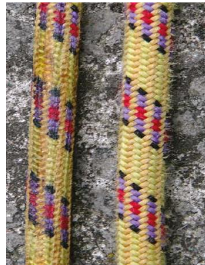
Obr. 9: Roztavenie vlákien plášťa.
