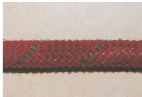
Obr. 14: Stmavnutie opletu pôsobením kyseliny.
