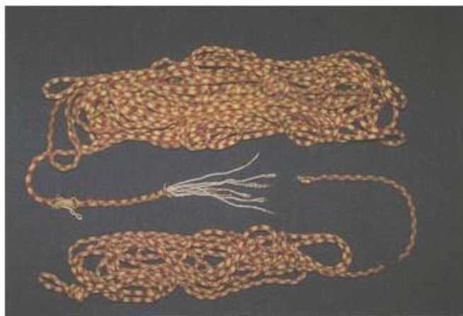
A - pretrhnutie na ostrej skalnej hrane B - prerezanie nožom
