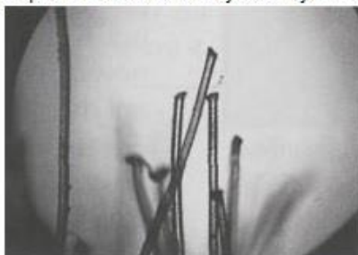
A - pretrhnutie na ostrej skalnej hrane B - prerezanie nožom
