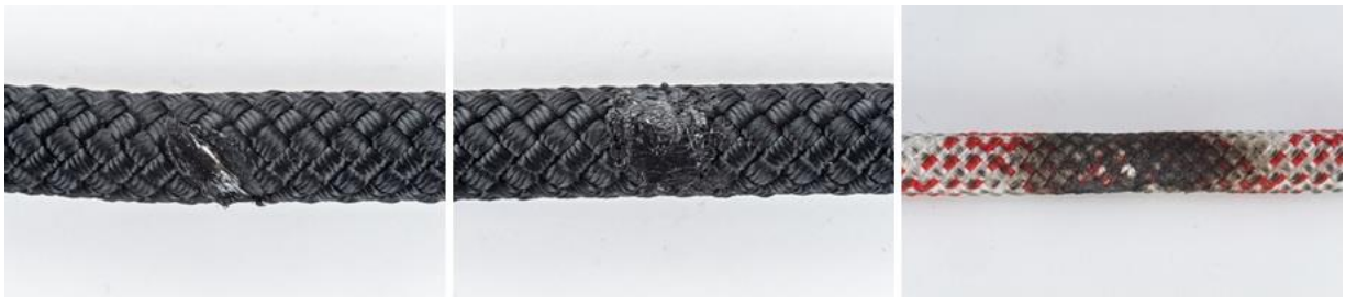
Obr. 19: Prepálenie opletu s externým zdrojom tepla.
