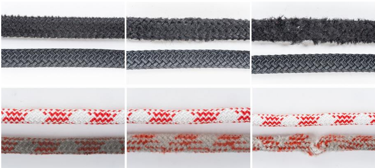
Obr. 16: Rôzne opotrebovanie lán.
