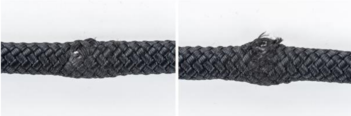
Obr. 23: Vážne poškodenie lana.
