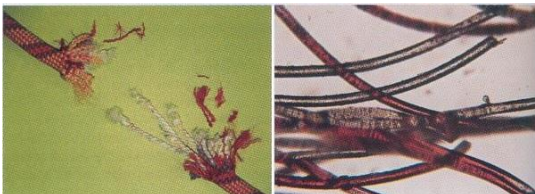
Obr. 13: Pohľad na pretrhnuté lano v dôsledku pôsobenia kyseliny a mikroskopická analýza poškodených polyamidových vlákien.
