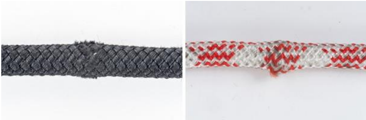
Obr. 22: Hernia jadra – vážne poškodenie jadra.
