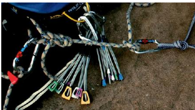
Obr. 6: Istenie v istiacom stanovisku vytvorenom slučkami (foto BMC)
